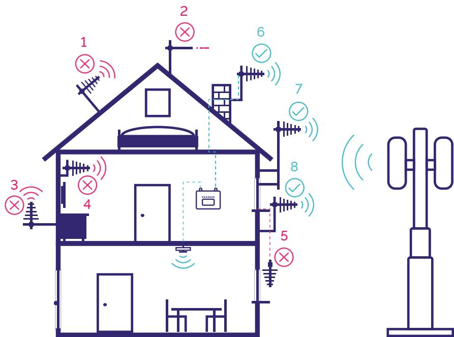
1. Installieren Sie die Antenne nicht auf der Dachneigung.
