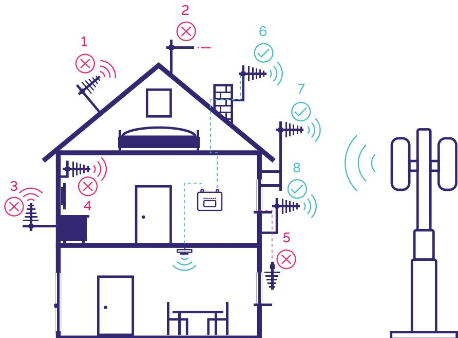
1. No instale la antena en la pendiente del techo.
