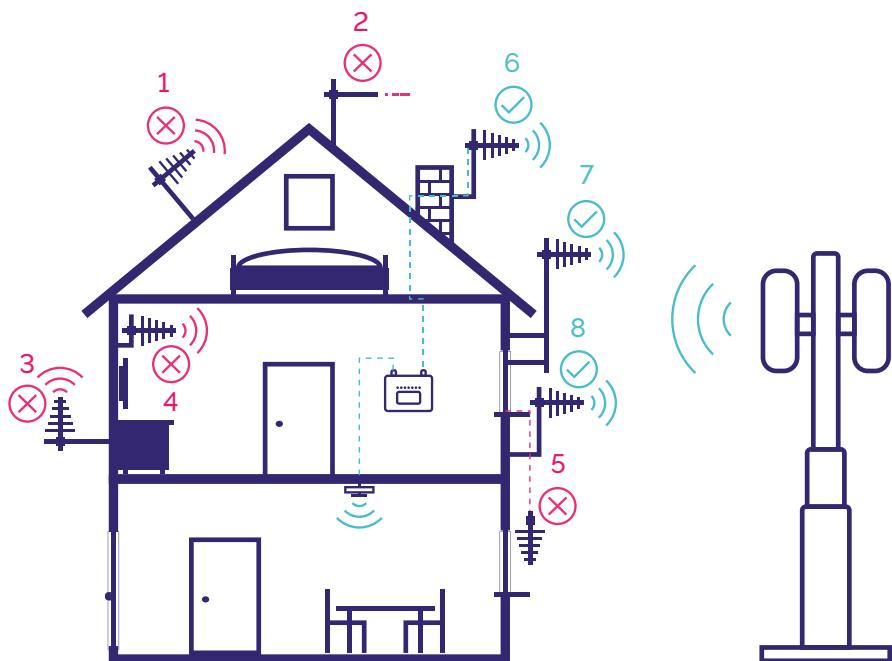
1. N'installez pas l'antenne sur la pente du toit.
